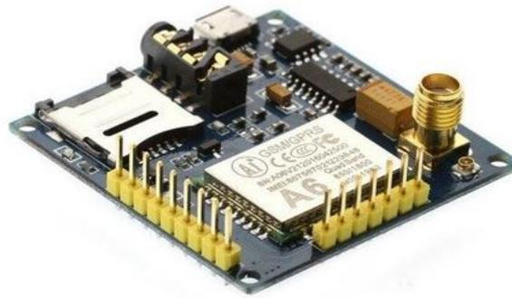
Figura 2. Módulo GSM GPRS A6 Cuatro Bandas.
