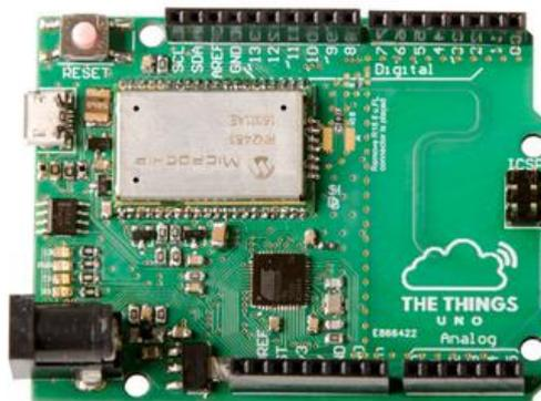
*Figura 3. The things Uno módulo de LoRaWAN 868 MHz*
