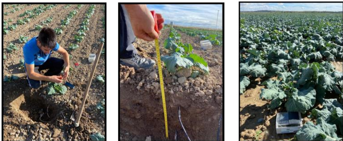
Figura 1. Instalación de las sondas de humedad en campo para el cultivo del brócoli (agosto 2022).
