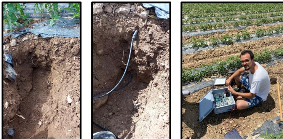
Figura 9. Instalación de las sondas de humedad en campo para el cultivo del tomate (junio 2023).
